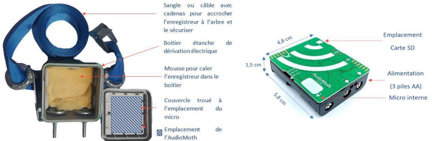
Figure 4 : Enregistreur Audiomoth et boîtier de protection
