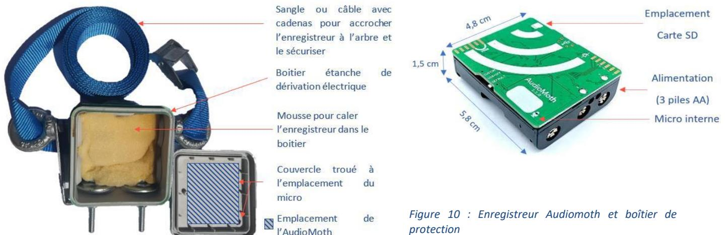
Figure 10 : Enregistreur Audiomoth et boîtier de protection
